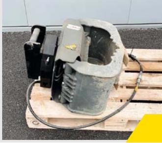
Magnetventil, Anbauplatte LH oder HD, Schlauchsatz und Kupplungen
