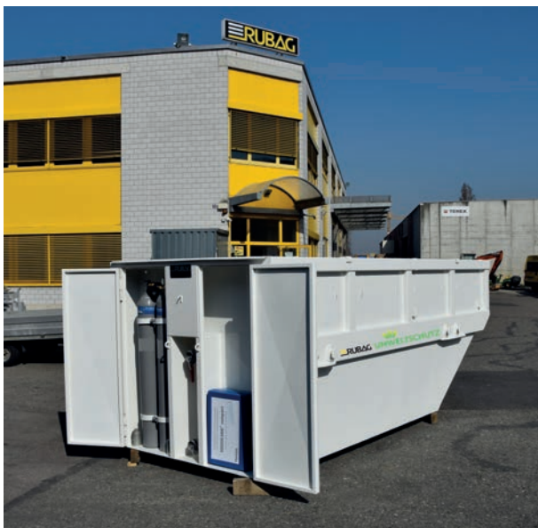
Absetzbecken mit integriertem Technik- und Gasschrank
