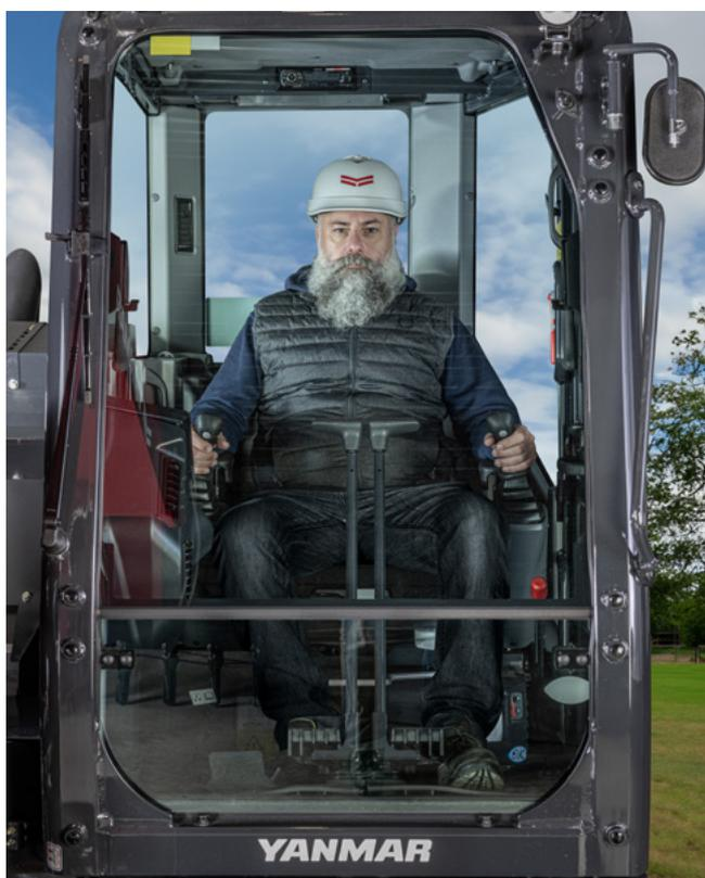
Die Kabine des SV86-7 2PB wurde so konzipiert, dass sie den Anforderungen des Fahrers gerecht wird. Die ergonomische Gestaltung des Arbeitsbereichs bietet Komfort, ist klar strukturiert und sorgt für mehr Produktivität bei langen Tagen auf der Baustelle. Die hervorragende Rundumsicht und das clevere Design garantieren ermüdungsfreies Arbeiten und maximale Sicherheit.
