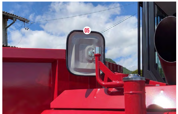
04 05 Nouveau rétroviseur pour siège en position arrière afin d'améliorer la visibilité latérale arrière gauche
