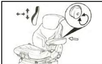
Tourner la poignée (flèche) indifféremment vers la gauche ou vers la droite pour régler le soutien lombaire en hauteur et en profondeur.
