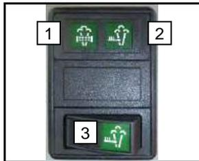
La lampe de cendres indique que le filtre à particules diesel s'est encrassé de façon permanente et ne peut plus être régénéré dans l'appareil.
