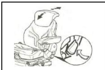
Le réglage de l'inclinaison du dossier se fait à l'aide d'une manette de blocage (flèche).
