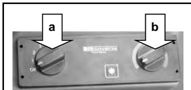
La cabine est équipée d'un chauffage réglage graduellement. Pour activer le chauffage, le commutateur « a » doit être mis sur « 1 » au moins !
