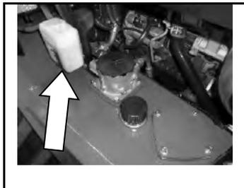
Le récipient du dispositif lave-glace se trouve sous le capot dans la partie arrière gauche du chariot arrière.
