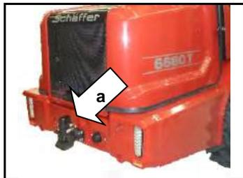
En option, la chargeuse peut être équipée d'un attelage de remorque. L'attelage peut être ouvert avec le levier « a ». L'attelage se ferme automatiquement en insérant l'œillet de traction.
