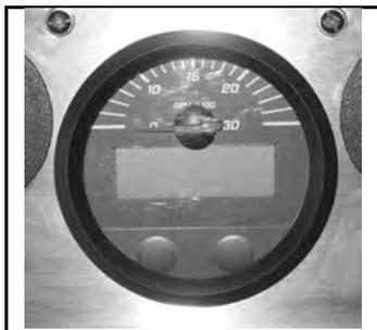
L'instrument d'affichage indique les erreurs moteur sous forme de numéro SPN.
