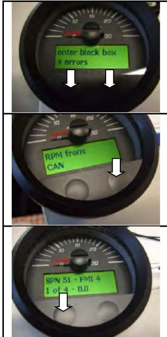
L'instrument AIS21001\_CANBUS enregistre les 20 dernières alertes/messages d'erreur. Si le nombre d'alertes est de >1, l'écran indique toujours la dernière alerte en faisant défiler les autres automatiquement.
