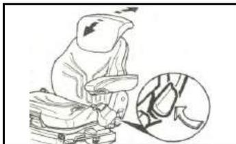
Le réglage de l'inclinaison du dossier se fait à l'aide d'une manette de blocage (flèche).
