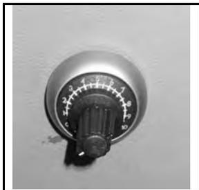
À l'aide du commutateur situé sur la barre, il est possible de changer la vitesse du moteur indépendamment de la vitesse de déplacement.
