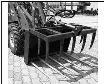
Les pinces à fumier et à désilage constituent un accessoire destiné à prélever et à transporter du fumier, de l'ensilage en vrac et de la fourrure crue en vrac.
