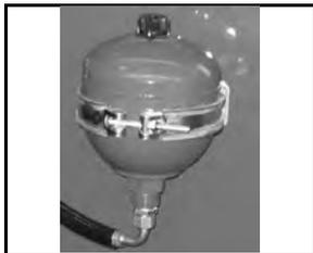
L'atténuateur de vibrations sert à atténuer les vibrations et chocs transmis du bras télescopique au châssis lors du transport à haute vitesse sur un trajet irrégulier. Cela permet de prévenir tout mouvement de la chargeuse lors de déplacements.
