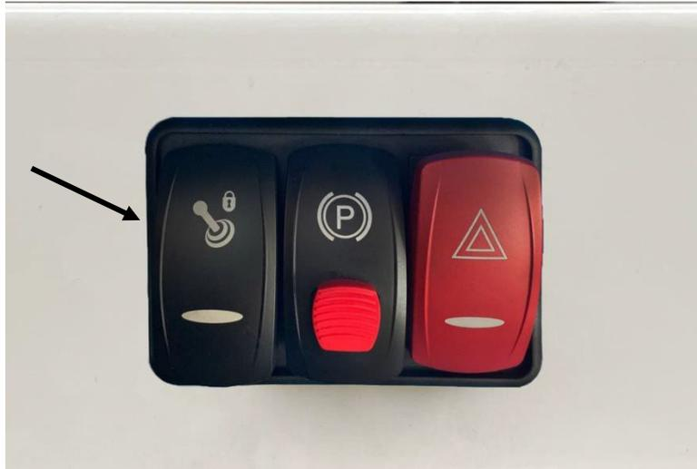
**Abbildung 23.** Sperrknöpfe der Joystick-Funktionalität
