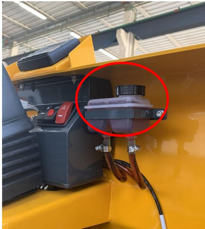
**Abbildung 41.** Bremsflüssigkeitsbehälter
