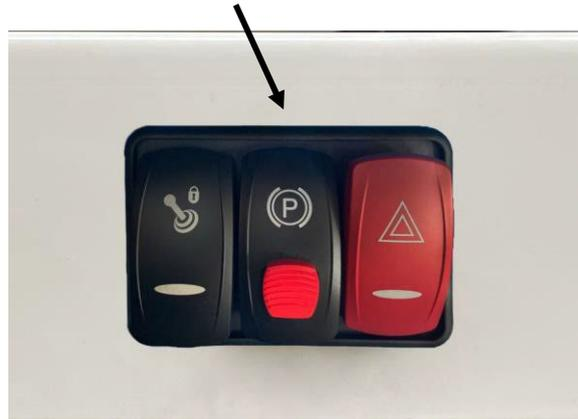
**Abbildung 14.** Knopf für die Feststellbremse
