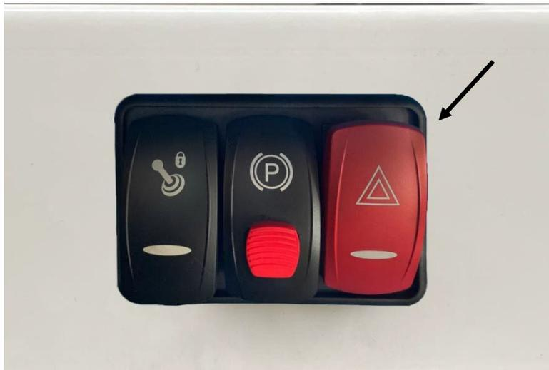
**Abbildung 21.** Warnblinkschalter
