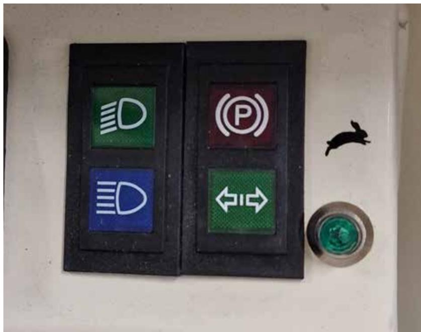
**Abbildung 20.** Warnleuchten auf der rechten Seite der Lenksäule
