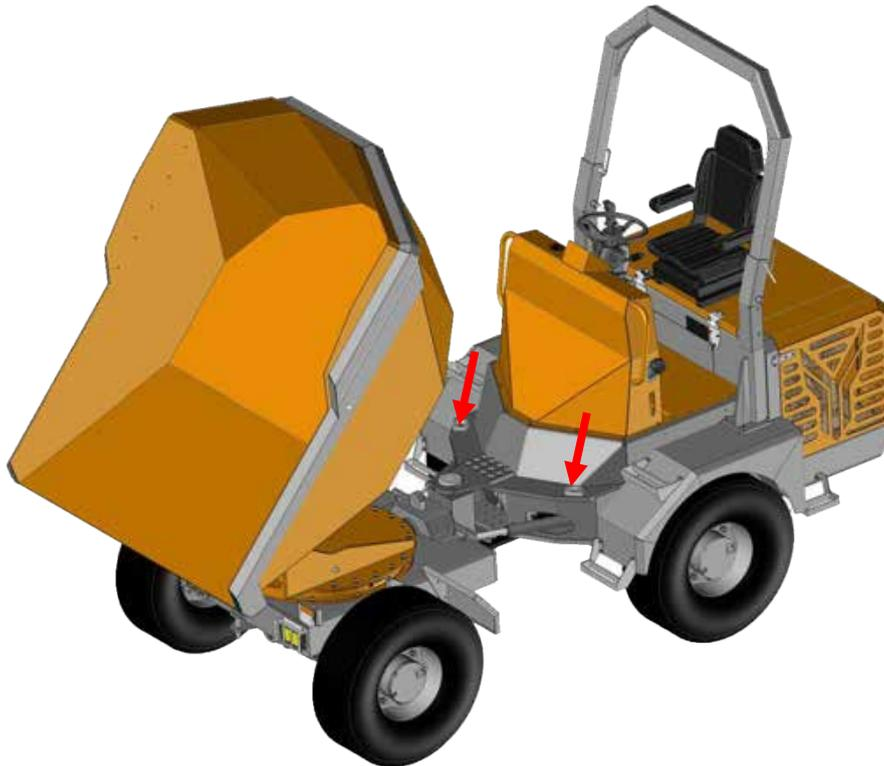
**Abbildung 25.** Haken zum Anheben des Fahrzeugs
