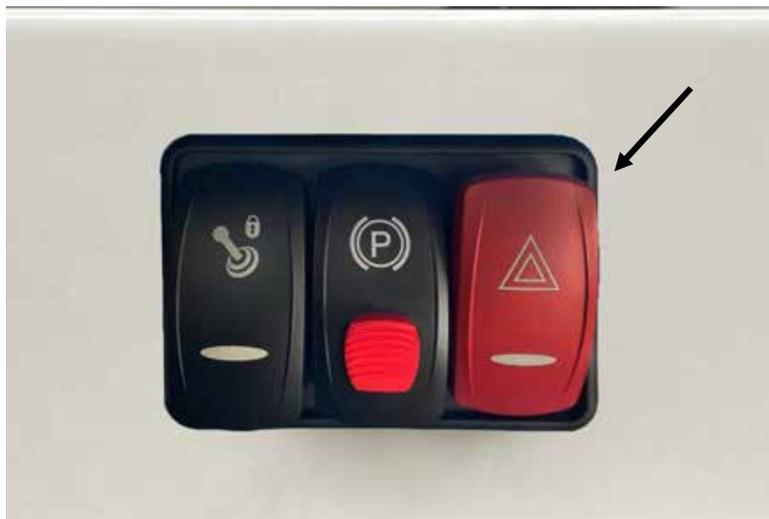
**Abbildung 21.** Warnblinkschalter
