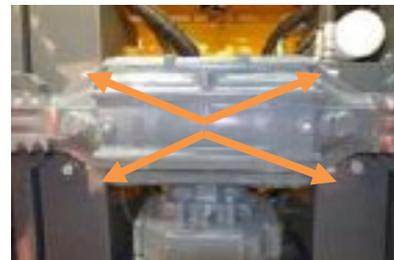
Nach dem Abschleppen muss die Federspeicher-Feststellbremse wieder aktiviert werden, d.h. die **Schrauben** herausdrehen, Distanzstücke auf die Schrauben setzen und Schrauben wieder an der Hinterachse montieren.
