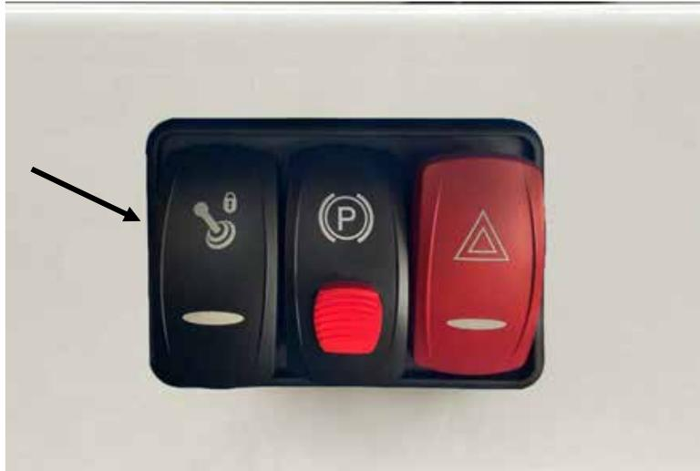
**Abbildung 23.** Sperren der Joystick-Funktionalität
