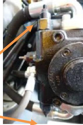
Nach dem Abschleppen beide Schrauben bis Anschlag zurückschrauben und Mutter wieder festziehen.
