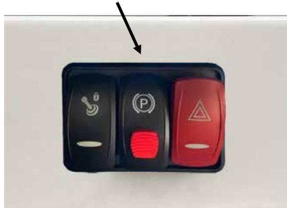
**Abbildung 14.** Knopf für die Feststellbremse
