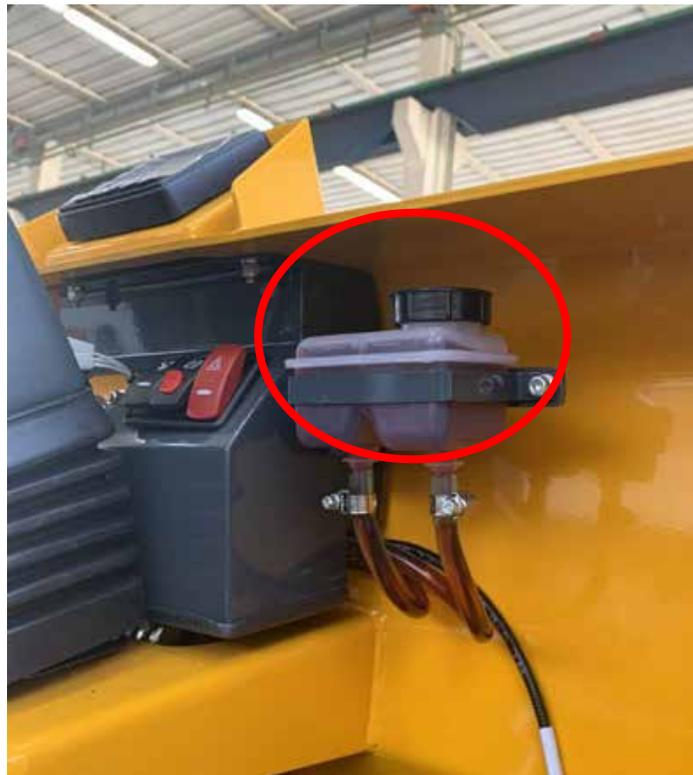
**Abbildung 41.** Bremsflüssigkeitsbehälter
