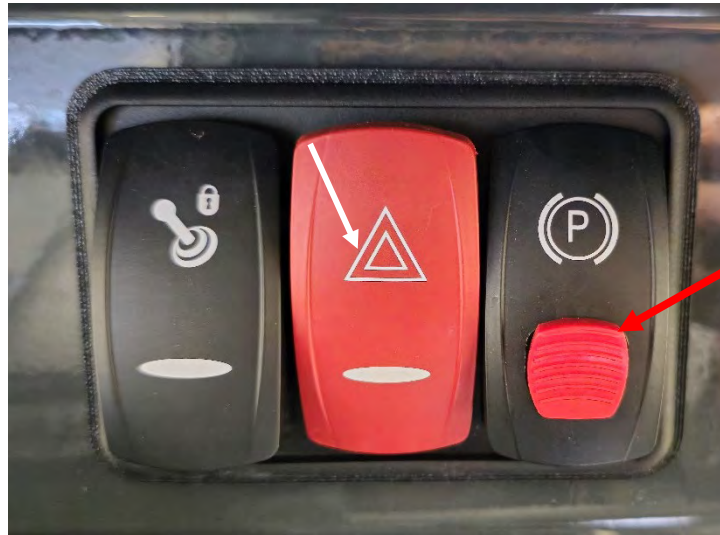
Abbildung 14. Knopf für die Feststellbremse Kontrolllampe Nr. 3 in Abbildung 20 leuchtet
