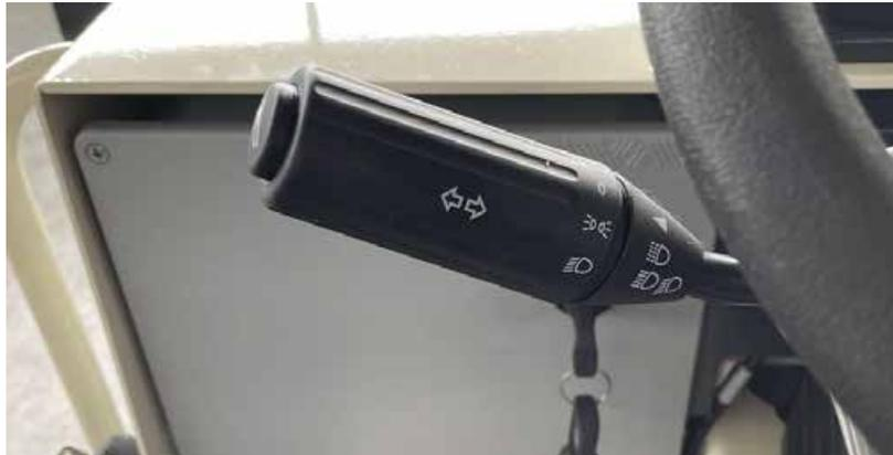
**Figure 18. interrupteur de la colonne de direction**
