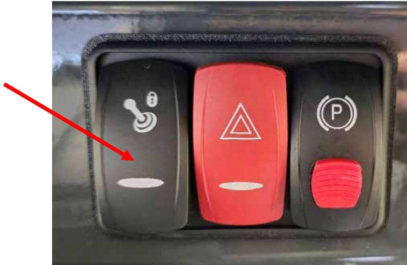
**Figure 23** : Verrouillage de la fonctionnalité du joystick
