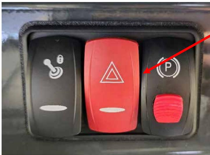
**Figure 21.** interrupteur des feux de détresse
