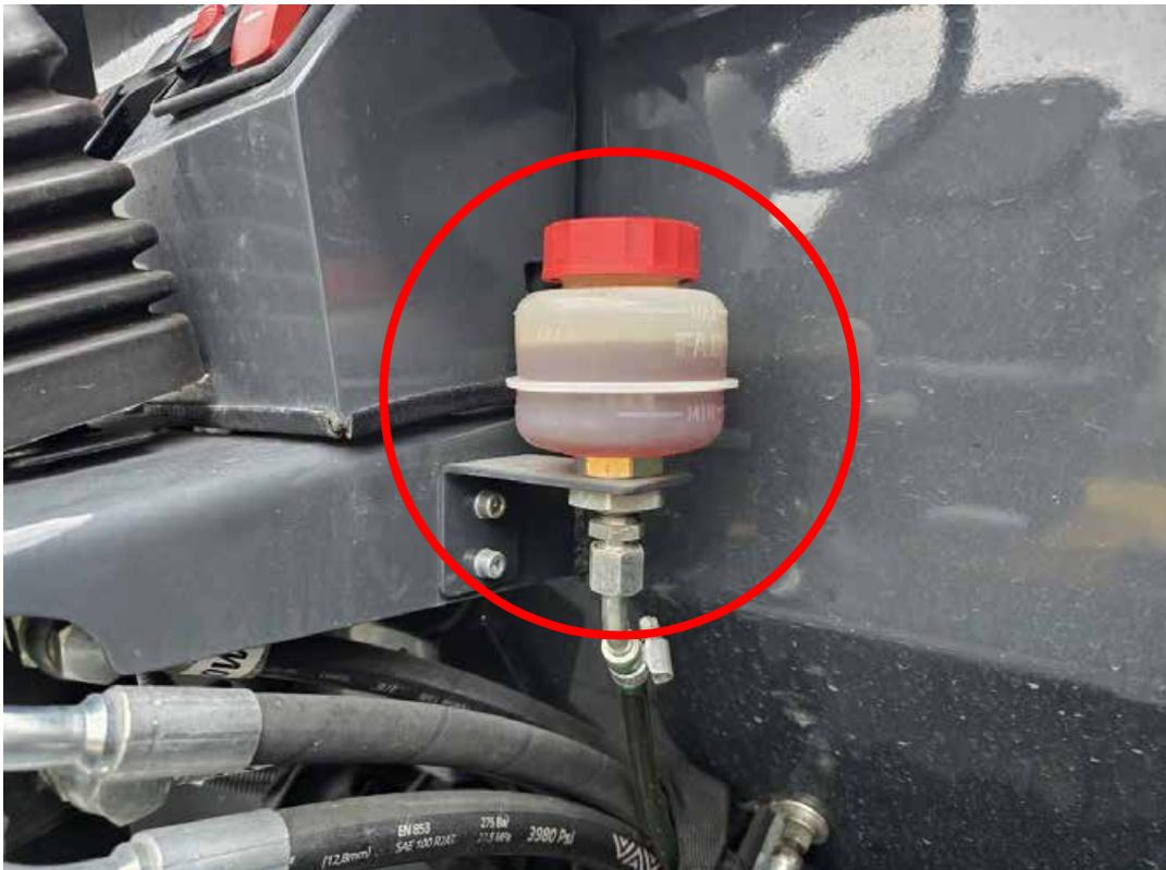
**Figure 41** : Réservoir de liquide de frein
