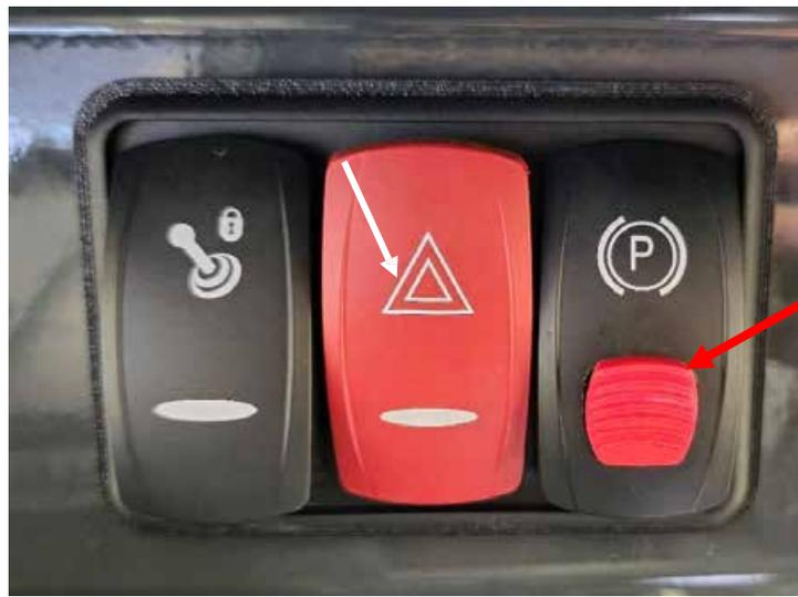
**Figure 14.** bouton du frein de stationnement Le témoin n° 3 de la figure 20 est allumé
