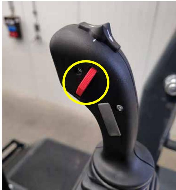
**Figure 13.** joystick avec levier de sélection des vitesses
