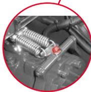
1. Feststellbremse lösen, falls es aufgrund von Stromausfall nicht möglich ist, muss die Bremse mechanisch gelöst werden. Dies geschieht indem die Schraube M 8 (SW 13), unter der Sitzklappe (siehe Abbildung) demontiert wird. Achtung! Federbelastet!
