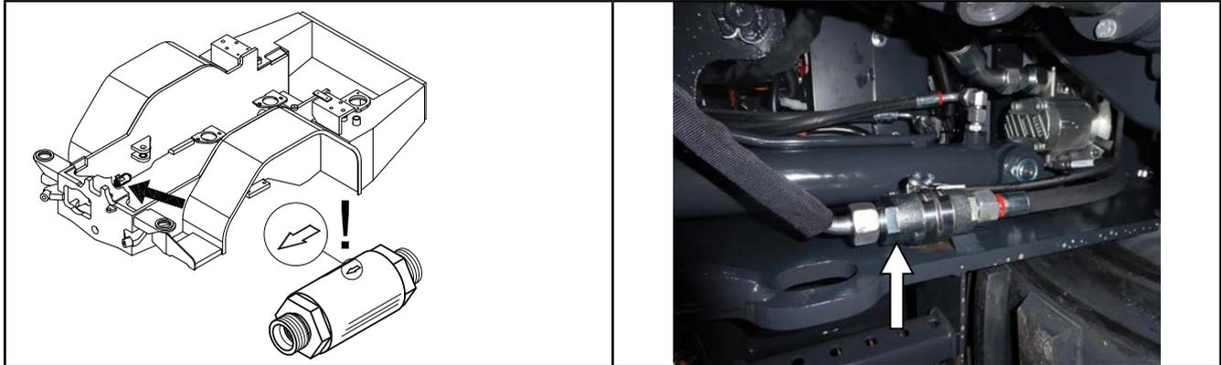
Das von der Zahnradpumpe geförderte Öl wird komplett durch den Druckfilter geleitet, bevor es zur Lenkung bzw. zum Steuergerät gelangt.
