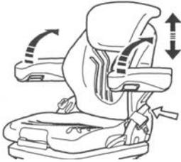
Die Armlehnen können bei Bedarf nach hinten geklappt und in der Höhe individuell angepasst werden.
