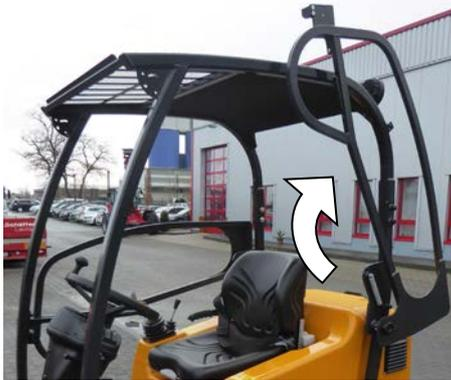
Zum Ein- und Aussteigen wird die Tür nach oben geklappt. So kann sie auch in engen Durchgängen geöffnet werden.
