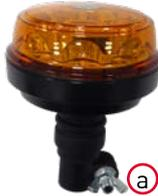
Die Rundumkennleuchte ist abnehmbar. Dazu die Flügelschraube (a) lösen und Leuchte nach oben abziehen.
