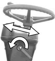
Die Lenksäule kann in Längsrichtung verstellt werden.
