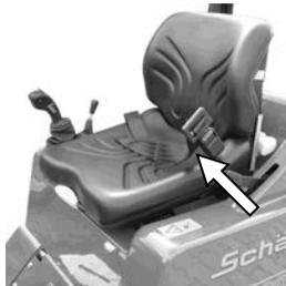
Der Fahrersitz ist mit einem Sicherheitsgurt (Beckengurt) ausgerüstet.
