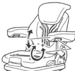
Vous pouvez modifier l'inclinaison des accoudoirs en tournant la roue à la main. En tournant la roue vers l'extérieur, la partie avant de l'accoudoir sera levée ; tourner la roue à la main vers l'intérieur permet d'abaisser l'accoudoir.
