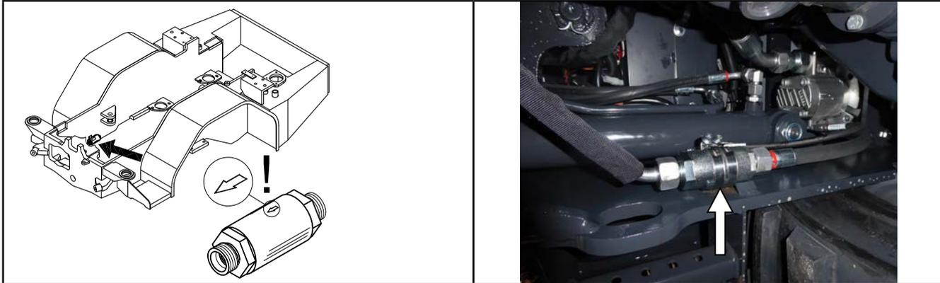
L'huile pompée par la pompe à roue dentée est entièrement guidée au travers du filtre sous pression avant d'arriver à la direction voire à l'appareil de commande.
