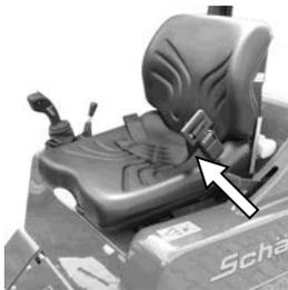
Le siège du conducteur est équipé d'une ceinture de sécurité (ceinture abdominale).
