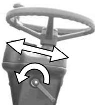
La console volant peut être réglée dans le sens longitudinal.
