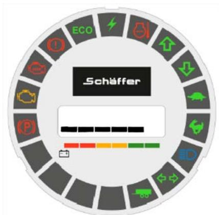
Le niveau de charge de la batterie est indiqué au moyen d'un témoin à six barres.
