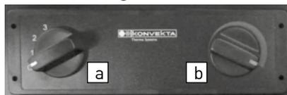
La cabine est équipée d'un chauffage réglage graduellement. Pour activer le chauffage, le commutateur « a » doit être mis sur « 1 » au moins !
