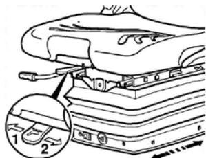
Grâce à l'amortisseur horizontal, le siège de conducteur peut mieux amortir les chocs dans le sens de la marche (par ex. si on roule à grande vitesse ou sur terrain difficile).
