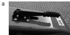
En position « a », le frein de parc est ouvert. Pour le tirer à fond, amener le levier en « b ». Le câble de commande sert à ajuster le frein de parc.
