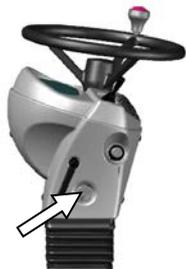
Un vibreur sonore d'alarme se situe à l'arrière de la colonne de direction. Celui-ci émet un signal en cas de surchauffe du moteur.
