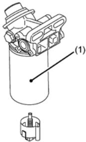
1. Der Wasserabscheider-Filter sollte alle 500 Betriebsstunden oder nach 1 Jahr durch ein Neuteil ersetzt werden.
