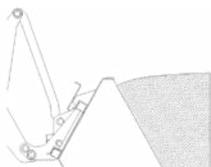
Zum Aufnehmen der Schüttgüter die Schaufel so weit auskippen, dass die Unterseite parallel zum Boden steht. Mit dem Lader langsam vorfahren, bis die Schaufel voll ist.
