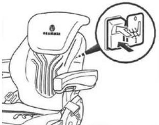
Die Sitzheizung wird durch Betätigung des Schalters ein- bzw. ausgeschaltet.
