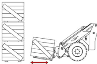
Zum Rangieren ist der Teleskoparm abzusenken und einzufahren, der Werkzeugzylinder ist voll einzukippen.
