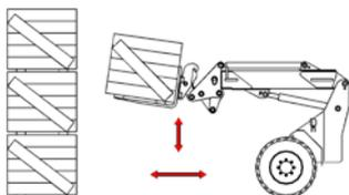
Den Teleskoparm im eingefahrenen Zustand langsam absenken.
