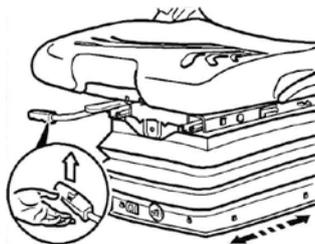
Durch Betätigen des Verriegelungshebels nach oben wird die Längseinstellung freigegeben.
