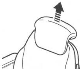
Die Rückenverlängerung kann in der Höhe durch Herausziehen oder Hineinschieben über spürbare Rasterungen bis zu einem Endanschlag individuell angepasst werden.
