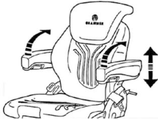
Die Armlehnen können bei Bedarf nach hinten geklappt und in der Höhe individuell angepasst werden.
