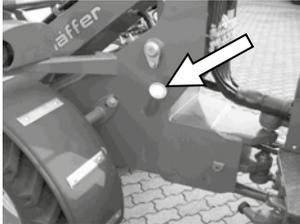
Der Tankstutzen für den Dieseltank befindet sich links am Vorderwagen.
