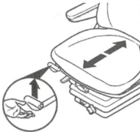
Durch Betätigen des Verriegelungshebels nach oben wird die Längseinstellung freigegeben.
