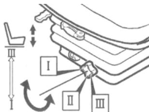
Die Höheneinstellung kann in drei Stufen (I, II, III) angepasst werden.
