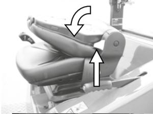
Die Rückenlehne festhalten und den Hebel an der linken Sitzseite nach oben drücken. Die Sitzlehne klappt automatisch um.
