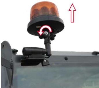
Die Rundumkennleuchte ist abnehmbar.
