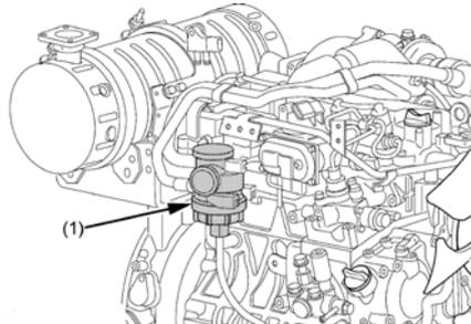
1. Entfernen Sie den Deckel, dann nehmen Sie das Ölabscheider-Element und den Dichtring heraus. Danach wischen Sie alle Öl- und Fettreste am Kontaktbereich ab.
