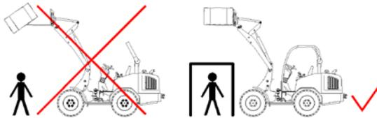
Fahrzeuge sind so zu beladen, dass sie nicht überlastet werden und während der Fahrt kein Material verlieren. Das Fahrzeug ist aus geringstmöglicher Höhe zu beladen.
