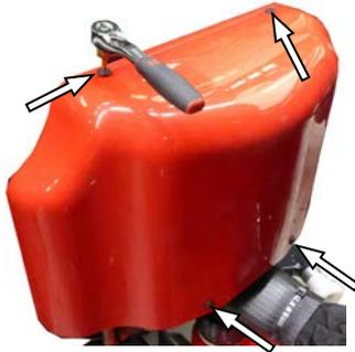
1. Lösen Sie die 4 Schrauben und entfernen vorsichtig die Kunststoffabdeckung.
