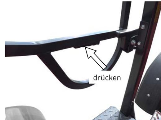
Die Tür wird über die Entriegelungstaste entriegelt.
