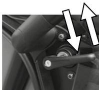
Während des Einsatzes sind die Kabinentüren ständig verriegelt zu halten. Die Tür kann bei Bedarf einen Spalt offen gehalten werden. Dazu ist der in der Abbildung gezeigte Hebel nach außen zu klappen und im Türschloss einzurasten (a).
