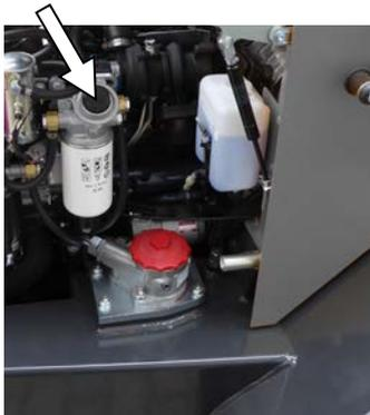
Zum Entlüften Pumpenknauf der Handpumpe mehrmals drücken bis das Drücken schwergängig wird.
