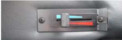
Die Kabine ist mit einer stufenlos regulierbaren Heizung ausgerüstet. Der Einstellhebel befindet in Fahrtrichtung rechts hinter dem Fahrersitz. Der Schalter für den Belüftungsventilator (siehe 4.2.4 Pos.: 6) muss eingeschaltet sein.
