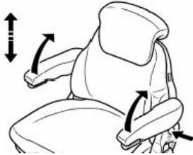
Die Armlehnen können bei Bedarf nach hinten geklappt und in der Höhe individuell angepasst werden.
