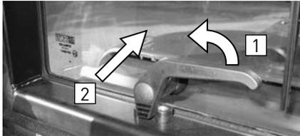
1. Zum Öffnen des Heckfensters sind die beiden Griffe rechts und links gleichzeitig zu schwenken.
