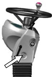
An der Rückseite des Lenkturms befindet sich ein Warnsummer. Dieser ertönt bei Überhitzung des Motors.
