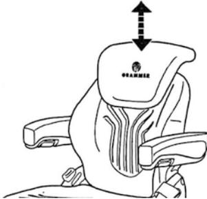
Die Rückenverlängerung kann in der Höhe durch Herausziehen über spürbare Rasterungen bis zu einem Endanschlag individuell angepasst werden.
