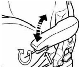
Die Längsneigung der Armlehne kann durch Drehen des Handrades verändert werden. Bei Drehung nach außen wird die Armlehne vorn angehoben, bei Drehung nach innen wird sie vorn abgesenkt.
