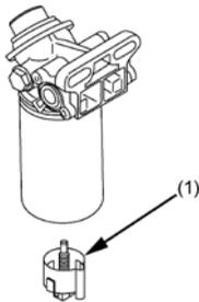
Wenn sich im Wasserabscheider Wasser oder andere Verunreinigungen angesammelt haben, kann das Wasser an der Schaltermontagegruppe abgelassen werden.
