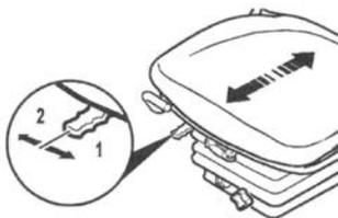
Unter bestimmten Betriebsbedingungen (z.B. Fahren mit Anhänger) ist es vorteilhaft, die Längshorizontalfederung einzuschalten. Dadurch können Stoßbelastungen in Fahrtrichtung durch den Fahrersitz besser abgefangen werden.
