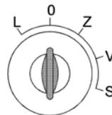
Zuerst den Zündschlüssel in Stellung „Z“ drehen. Es ist zu kontrollieren ob der Fahrtrichtungsschalter in Neutralstellung ist, die Feststellbremse muss angezogen sein. Danach den Schlüssel zum Vorglühen in Position „V“ drehen und solange halten bis die Kontrolllampe „Vorglühen“ im Kombi-Instrument verloschen ist. Zum Starten des Dieselmotors wird der Schlüssel in Stellung „S“ weitergedreht.
