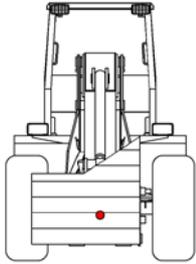
Unregelmäßig verteilte Lasten sind so zu heben, dass es nicht zum Umkippen des Laders kommt. **Der Lastschwerpunkt hat sich in der Mitte beider Gabelzinken zu befinden!**
