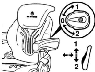
Mit der Lendenwirbelstütze kann sowohl der Sitzkomfort erhöht als auch die Leistungsfähigkeit des Fahrers erhalten werden.
