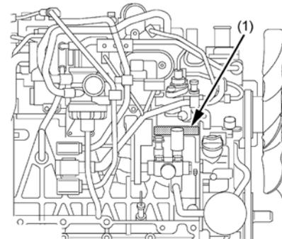
**Kennzeichnung Hydraulikpumpe und -motor**
