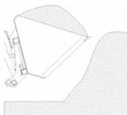
Den Teleskoparm etwas anheben und die Schaufel ganz einkippen. Mit abgesenktem Teleskoparm zum Abladeplatz fahren und erst dort den Teleskoparm zum Abladen anheben.
