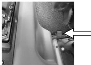
Die Sicherung für den Luftfedersitz (15 A) befindet sich rechts hinter dem Sitz.
