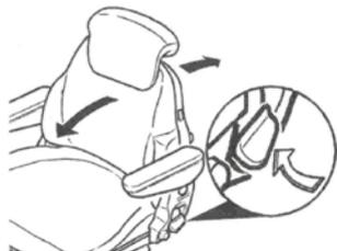
Zum Entrasten der Rückenlehne den Verriegelungshebel nach oben ziehen. Die Rückenlehne beim Entrasten nicht durch dagegen Drücken belasten.
