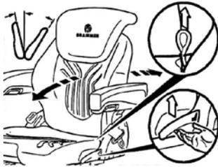
Zum Entrasten der Rückenlehne den Verriegelungshebel nach oben ziehen.
