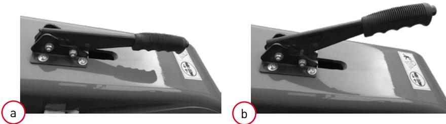
In Position „a“ ist die Feststellbremse gelöst. Zum Festziehen ist die Bremse in Position „b“ zu bringen. Die Feststellbremse kann am Seilzug eingestellt werden.
