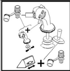
Bei der elektrisch-proportionalen-Steuerung gibt es 2 Möglichkeiten die Zusatzhydraulik zu betätigen:
