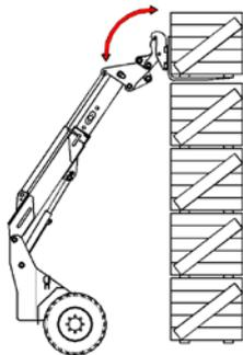
Beim Aufnehmen einer Last aus Stapeln sind die folgenden Arbeitsschritte einzuhalten: Lader im rechten Winkel an den Stapel heranzufahren, Teleskoparm heben und ausfahren. Last mit der Gabel aufnehmen und dann den Teleskoparm langsam anheben. Den Werkzeugzylinder einziehen um die Standsicherheit zu erhöhen.
