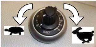
Mit dem Geschwindigkeitsregler kann die Fahrgeschwindigkeit unabhängig vom Gaspedal eingestellt werden. Die gewünschte Fahrgeschwindigkeit wird über die Verdrehung des Potis eingestellt.
