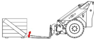
Bei Ladearbeiten ist der Teleskoparm immer in die möglichst tiefste Stellung zu bringen.
