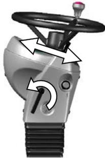
Die Lenksäule kann in Längsrichtung verstellt werden.
