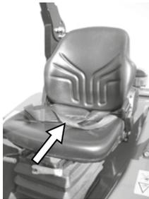
Der Fahrersitz ist mit einem Sicherheitsgurt (Beckengurt) ausgerüstet.
