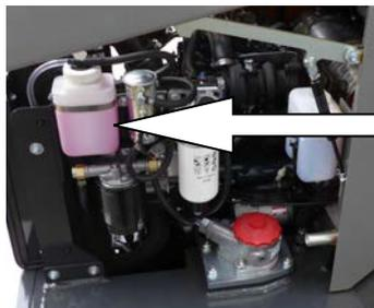
**Réservoir du système de refroidissement**
