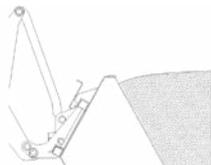
Pour charger les matières en vrac, faire basculer la pelle jusqu'à ce que la face inférieure soit positionnée parallèlement au sol. Faire avancer la chargeuse jusqu'à ce que la pelle soit pleine.
