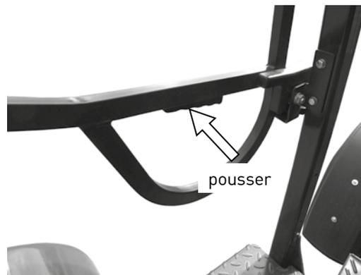
La porte se déverrouille à l'aide du bouton de déverrouillage.
