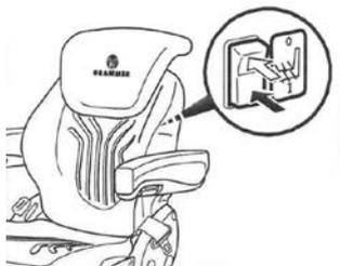
Actionnez l'interrupteur pour activer ou désactiver le chauffage du siège.
