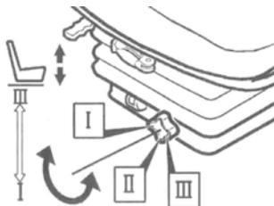
Le réglage de la hauteur peut être adapté à raison de 3 degrés (I, II, III).
