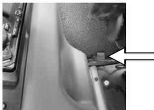
Le fusible du siège à suspension pneumatique (15 A) se trouve à droite derrière le siège.
