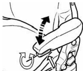
Vous pouvez modifier l'inclinaison des accoudoirs en tournant la roue à la main. En tournant la roue vers l'extérieur, la partie avant de l'accoudoir sera levée ; tourner la roue à la main vers l'intérieur permet d'abaisser l'accoudoir.
