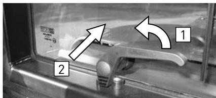
1. Pour ouvrir la vitre arrière, basculer les deux poignées à droite et à gauche en même temps.
