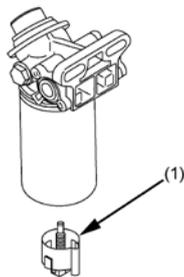
Si de l'eau ou d'autres impuretés se sont accumulées dans le séparateur d'eau, le liquide au niveau de l'ensemble commutateur peut être relâché.
