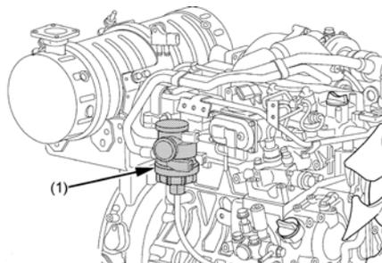
1. Enlever le couvercle et retirer l'élément du séparateur de l'huile et la rondelle d'étanchéité. Ensuite éliminer l'huile et la graisse de la surface en question.
