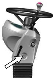
Un vibreur sonore d'alarme se situe à l'arrière de la console volant. Celui-ci émet un signal en cas de surchauffe du moteur.
