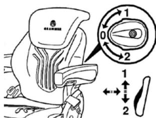
Le support lombaire permet d'augmenter aussi bien le confort de l'assise que la liberté de mouvement du conducteur.
