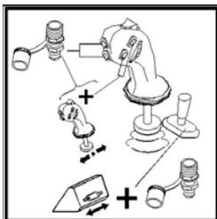
La commande électro-proportionnelle offre 2 possibilités pour commander l'hydraulique auxiliaire :
