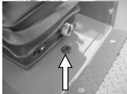
Déverrouiller la trappe du siège et la soulever. Elle est maintenue dans la position supérieure par un vérin à gaz.
