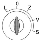
Tourner dans un premier temps la clé de contact sur la position « Z ». Il convient de contrôler si l'inverseur de marche est sur la position neutre ; le frein de parc doit être serré. Ensuite, tourner la clé pour le préchauffage sur la position « V » et maintenir jusqu'à ce que la lampe de contrôle « préchauffage » sur l'instrument combiné soit éteinte. Pour démarrer le moteur Diesel, la clé est tournée sur la position « S ».
