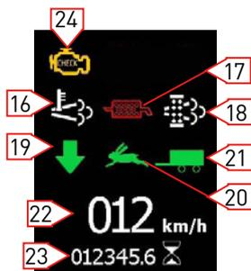
**16 = Voyant de contrôle de température gaz d'échappement**
