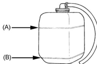
**Réservoir du système de refroidissement**
