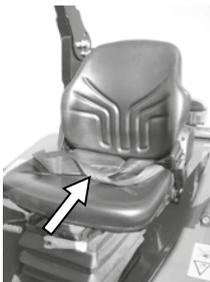
Le siège du conducteur est équipé d'une ceinture de sécurité (ceinture abdominale).
