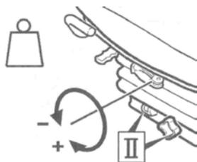
Le siège doit être réglé en fonction du poids du conducteur lorsque celui-ci est assis sur le siège en tournant la manette de réglage du poids.
