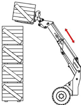
Enfin si la charge est stable, rentrez le bras télescopique et éventuellement reculer avec la chargeuse.
