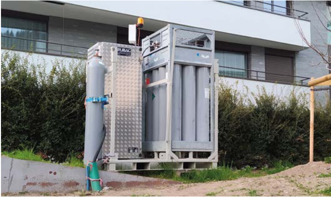
Spezialanfertigung Helikopter-Traggestell mit automatischer Neutralisationsanlage. Platz für ein Gasbündel oder Einzelflaschen
