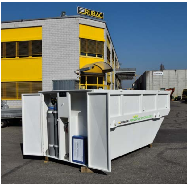
Absetzbecken mit integriertem Technik- und Gasschrank
