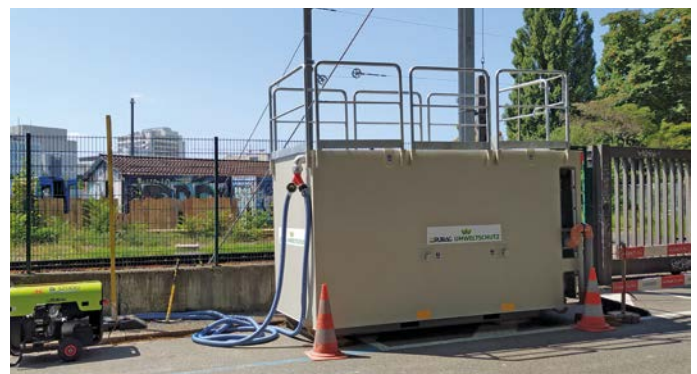
10 m 3 Becken mit integriertem Technik- und Gasschrank
