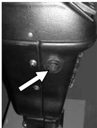
Un vibreur sonore d'alarme se situe à l'avant de la console volant. Celui-ci émet un signal en cas de surchauffe du moteur.
