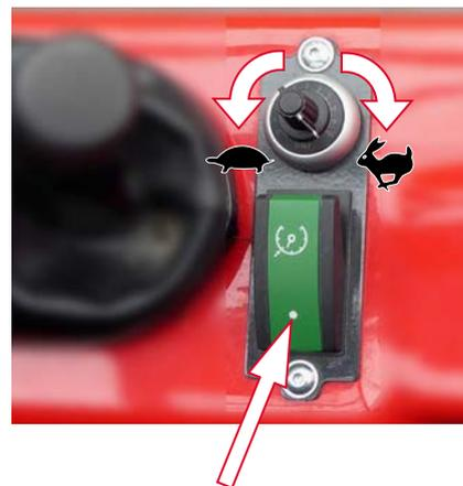
Interrupteur d'arrêt d'urgence du régulateur de vitesse
