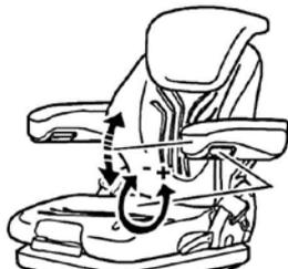
Vous pouvez modifier l'inclinaison des accoudoirs en tournant la roue à la main. En tournant la roue à la main vers l'extérieur **(+)**, la partie avant de l'accoudoir sera levée. Tournant la roue à la main vers l'intérieur **(-)** permet d'abaisser l'accoudoir.
