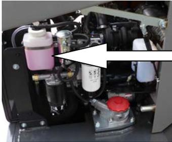
**Réservoir du système de refroidissement**
