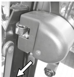
Monter et descendre du véhicule doit se faire uniquement sur le côté gauche, sinon il y a un risque d'actionnement involontaire du bras de levage. Le côté droit du véhicule est prévu pour l'issue de secours.
