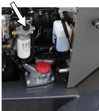
Pour purger l'air, appuyer plusieurs fois sur le pommeau de la pompe à main jusqu'à ce qu'une résistance apparaisse lors de l'appui.
