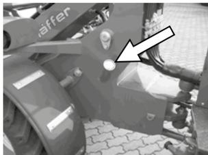
La tubulure du réservoir de carburant Diesel se trouve à gauche sur le chariot avant. Après avoir fait le plein, refermer soigneusement la tubulure du réservoir.
