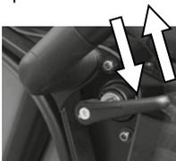
Les portes de la cabine doivent rester fermées pendant le travail. En cas de besoin, la porte peut rester entre-ouverte. A cet effet, rabattre le levier indiqué sur la figure ci-contre vers l'extérieur et l'encliqueter dans la serrure de la porte (a).
