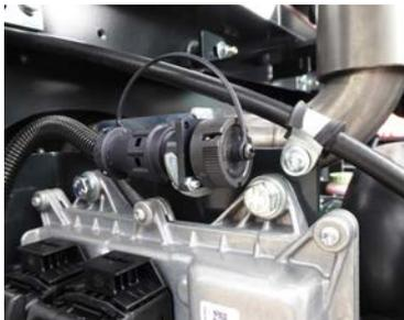
Les diagnostics de la prise OBD situé sous le capot moteur, à gauche dans le sens de la marche. Les diagnostics de la prise OBD peuvent être consultés et analysés par un atelier spécialisé compétent.
