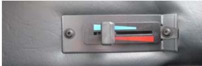
La cabine est équipée d'un chauffage réglable graduellement. Le levier de réglage se situe du côté droit, derrière le siège conducteur. L'interrupteur de la ventilation (voir 4.2.4 pos. 6) doit être en position Marche.
