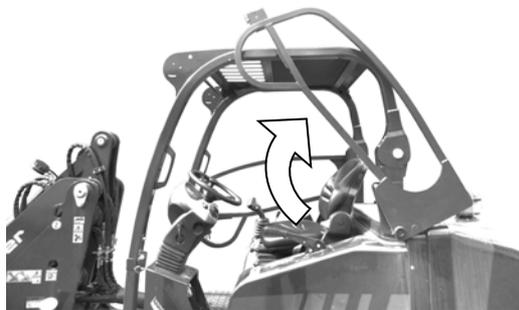
La porte peut être relevée pour monter et descendre sur la machine. Il est ainsi possible de l'ouvrir même dans un passage étroit.
