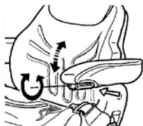
L'inclinaison longitudinale de l'accoudoir peut être réglée en tournant le volant (flèche).
