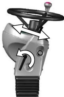
La colonne de direction peut être réglée dans le sens longitudinal.
