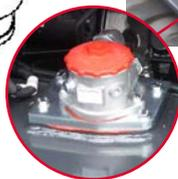
Soupape de ventilation remplissage
