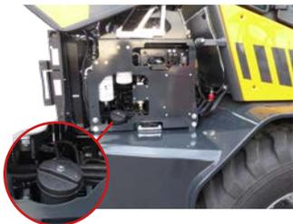
La tubulure du réservoir de gasoil est située du côté droit du chariot arrière sous le capot moteur.
