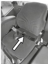
Le siège du conducteur est équipé d'une ceinture de sécurité (ceinture abdominale).
