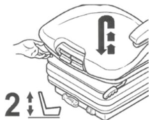
Le réglage de la hauteur peut être adapté à raison de 3 degrés (I, II, III).
