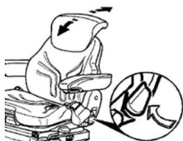
Le réglage de l'inclinaison du dossier se fait à l'aide d'une manette de blocage (flèche).
