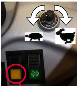
Le régulateur de vitesse permet de régler la vitesse indépendamment de la pédale d'accélérateur. La vitesse d'avancement souhaitée se règle en tournant le bouton du régulateur.
