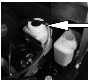
Réservoir du système de refroidissement
