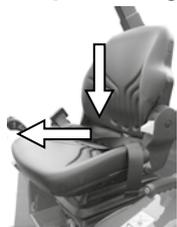
Pour ouvrir la trappe du siège, mettre celui-ci dans sa position la plus basse et le pousser légèrement en avant.
