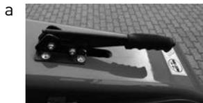
En position « a », le frein de parc est ouvert. Pour le tirer à fond, amener le levier en « b ». Le câble de commande sert à ajuster le frein de parc.
