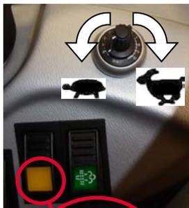
Le régulateur de vitesse permet de régler la vitesse indépendamment de la pédale d'accélérateur. La vitesse de conduite souhaitée se règle en tournant le potentiomètre.
