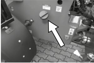
La tubulure du réservoir de carburant Diesel se trouve à gauche sur le chariot avant. Après avoir fait le plein, refermer soigneusement la tubulure du réservoir.
