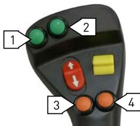
1. Système hydraulique supplémentaire 4<sup>ème</sup> circuit de commande ou commande ELPRO
