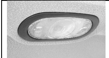
Leuchte durch Tür geschaltet:
