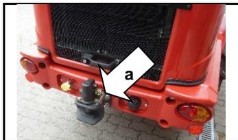
En option, la chargeuse peut être équipée d'un attelage de remorque. L'attelage peut être ouvert avec le levier « a ». L'attelage se ferme automatiquement en insérant l'œillet de traction.
