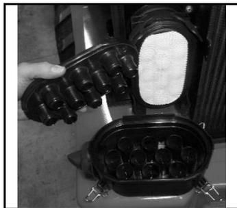
Le séparateur cyclonique est intégré au couvercle du filtre à air.
