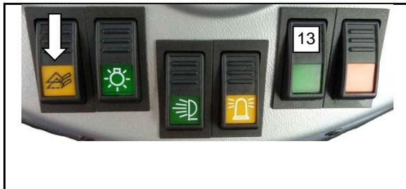
Les raccords de l'hydraulique supplémentaire sont sous pression. Si un accessoire doit être accouplé ou découplé à l'hydraulique supplémentaire, il faut dépressuriser les raccords.
