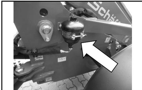
L'atténuateur de vibrations sert à atténuer les vibrations et chocs transmis du bras télescopique au châssis lors du transport à haute vitesse sur un trajet irrégulier. Cela permet de prévenir tout mouvement de la chargeuse lors de déplacements.
