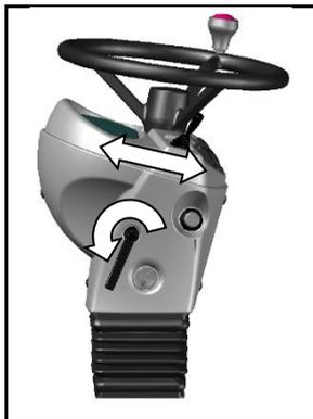
La colonne de direction peut être réglée dans le sens longitudinal.
