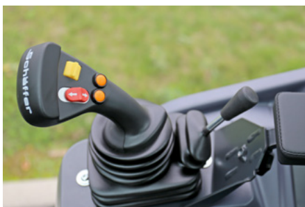
Neuer Joystick mit erweitertem Funktionsumfang
