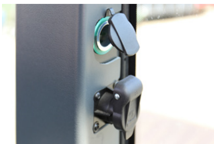
12 Volt-Steckdose zum Laden von Mobilgeräten / 3-polige Geräte-Steckdose
