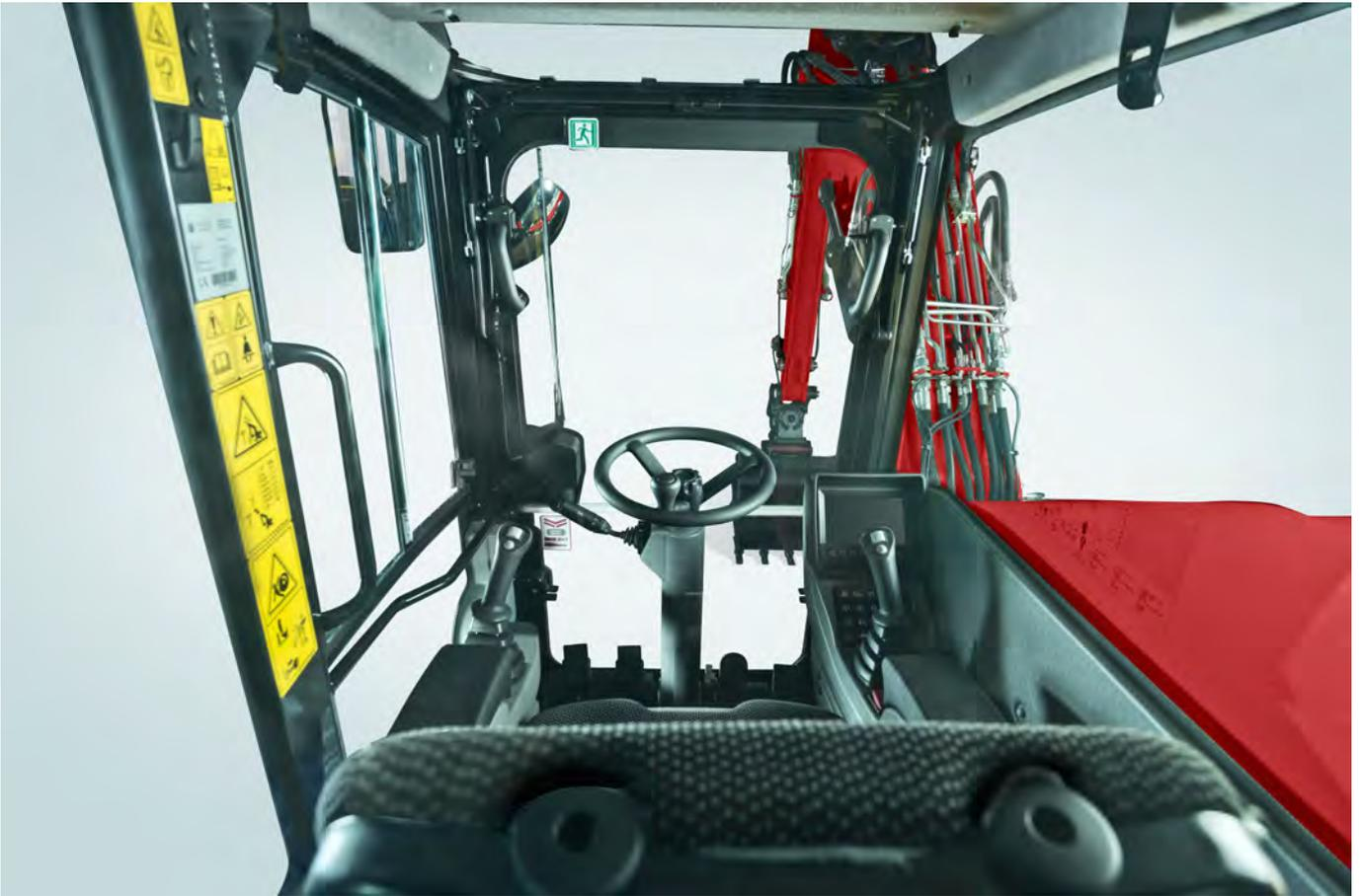
Die für Bedienerkomfort und Produktivität konzipierten Kabinen verfügen über Geräusch- und Vibrationsdämpfung sowie ROPS- und optionaler FOPS-Zulassungen.
