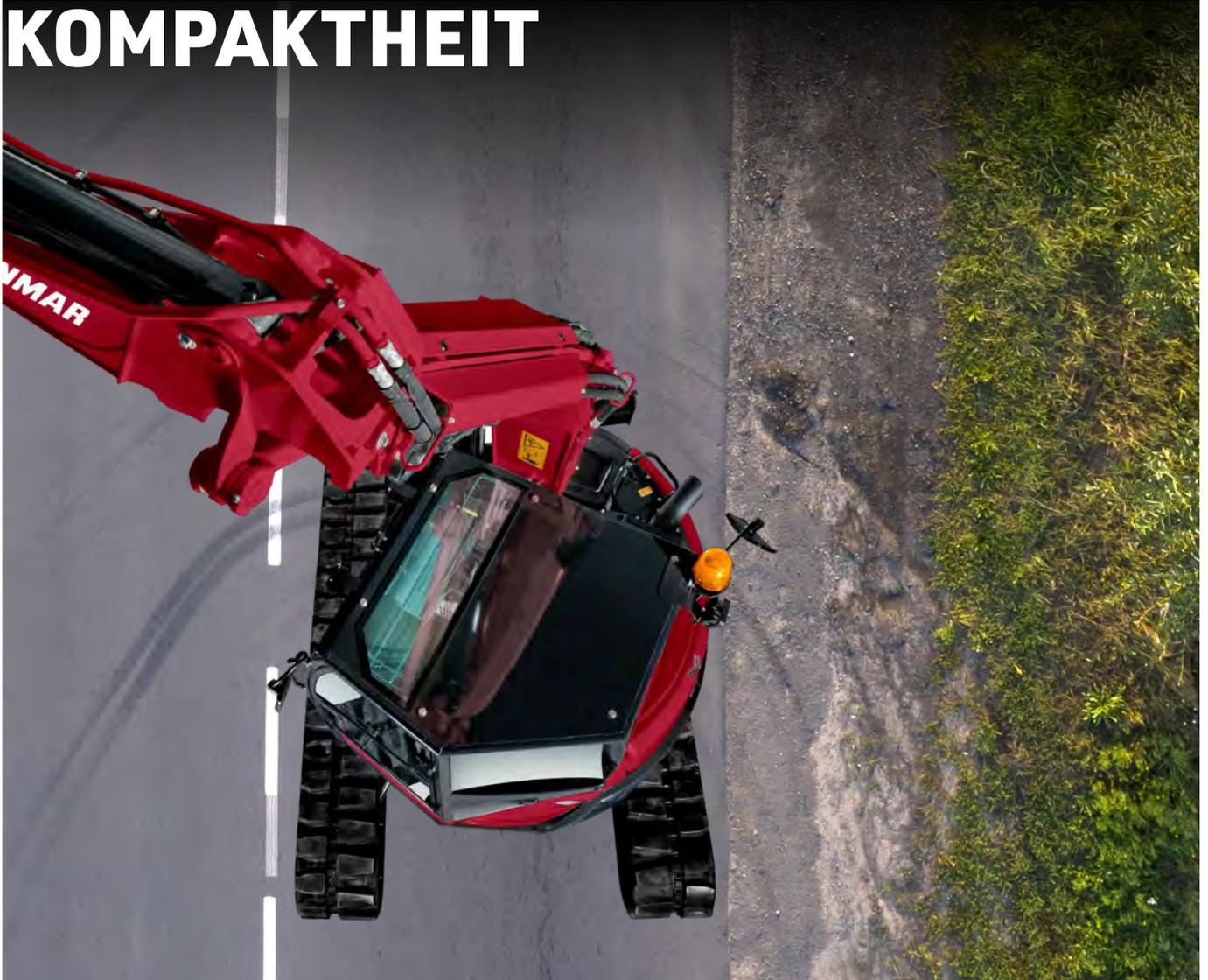
Beim Arbeiten mit maximaler Versetzung in engen Gräben stößt der zweite Teil des Auslegers, im Unterschied zu klassischen Baggern, nicht gegen die linke Schalung.
