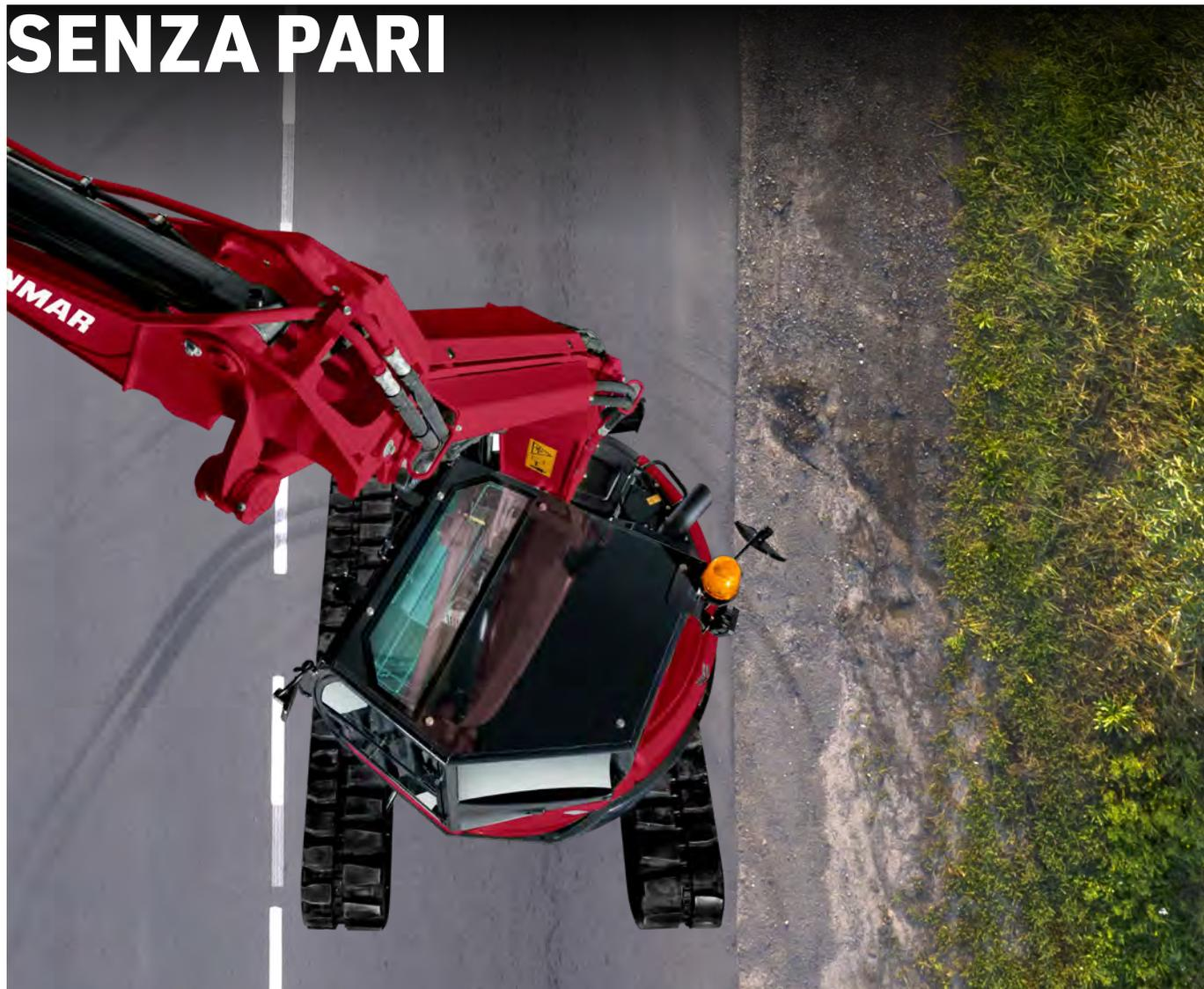
Lavorando con lo snodo tra il primo e secondo elemento del braccio quando si scavano trincee strette, non si corre il rischio d'interferire con le pareti delle stesse.
