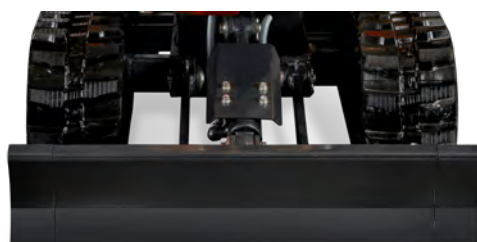
Châssis élargi 840 mm – Stabilité accrue
