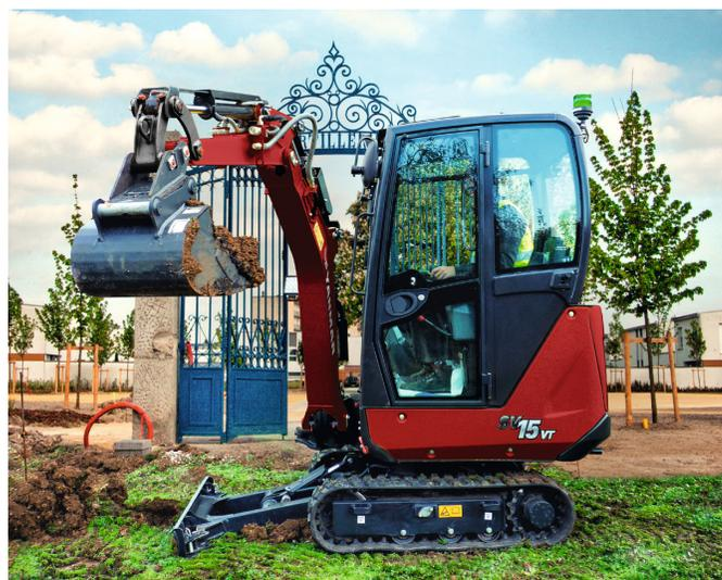
Affidabile e potente, il modello SV15vr è dotato di un sistema idraulico con una doppia pompa a ingranaggi, che fornisce 26 l/min a una pressione massima di 205 bar. La macchina è provvista di una linea idraulica ausiliaria standard per alimentare i demolitori o le trivelle, con una portata di 29 l/min a una pressione massima di 120 bar.
