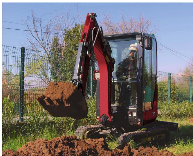
L'SV17vr offre prestazioni operative di tutto rispetto. Ha una forza di penetrazione di 9,9 kN e la sua forza di scavo raggiunge i 16 kN. Ha due velocità di trasferimento (2,4 / 4,8 km/h). La forza di trazione dei cingoli passa da 8 a 12,8 kN, in funzione della marcia di traslazione selezionata tramite un pulsante sulla leva della lama. Questa macchina offre prestazioni paragonabile a quelle di un modello di classe superiore.
