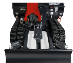
Eingefahrener Unterwagen : 980 mm
