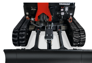
Ausgefahrener Unterwagen : 1 380 mm
