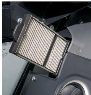
Anche i filtri dell'aria sono stati posizionati in spazi di facile accesso, per consentire una manutenzione rapida e semplice.
