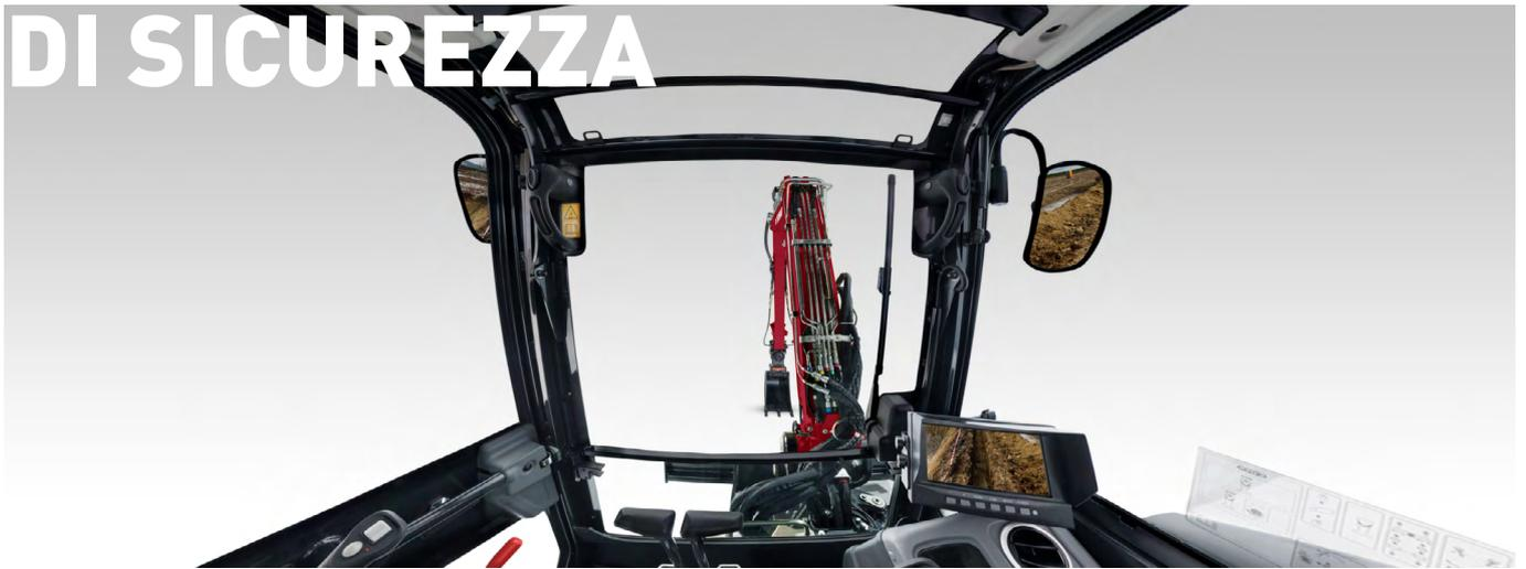
La cabina SV60-6B è stata progettata per soddisfare le certificazioni ROPS (Roll-Over Protective Structure) e FOPS (Falling Object Protective Structure) livello 1. La cabina può essere dotata di protezione FOPS livello 2 (protezione anteriore e superiore) come optional.
