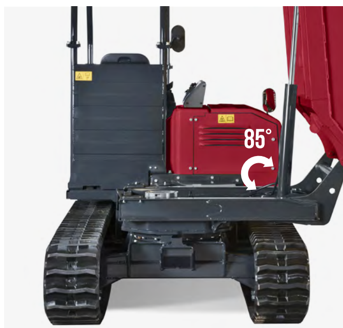
BENNE PIVOTANTE AVEC ROTATION À 180°
