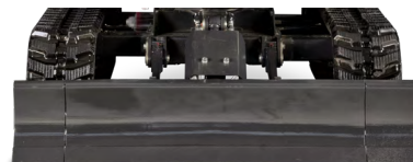
Ausgefahrener Unterwagen: 1280 mm
